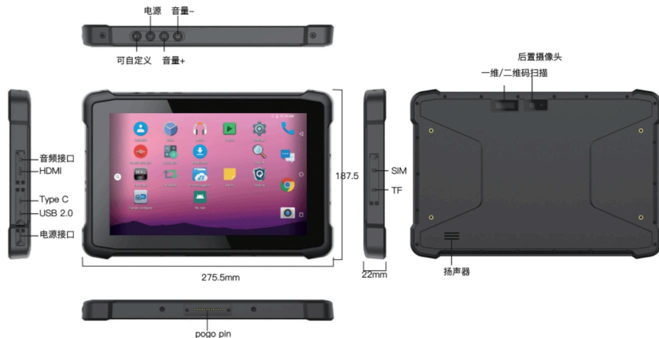
GPC-G10Z是一款坚固三防平板电脑, 支持Android9.0操作系统,安全性高, 操作方便;采用MSM 8953 8核芯片, 性能大幅度提升, 优化工作效率和性能。10.1寸高清显示IPS 电容屏, 配备3.7V/8000mAh内置聚合物锂离子电池, 提升机器续航能力,保证工作时长与延续。
